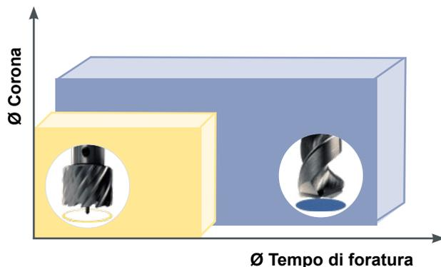
La carotatura è notevolmente più economica della perforazione con punta elicoidale e riduce drasticamente la durata del processo di perforazione.
