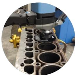
Versatile sbavatura e smussatura di contorni, raggi e fori stretti, cordone di saldatura 30° / 45° e preparazione del bordo visibile, ecc.
