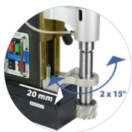
Colonna orientabile di 15° Dx/Sx, scorrevole di 20 mm. La base magnetica regolabile consente un posizionamento preciso del centro foro.
