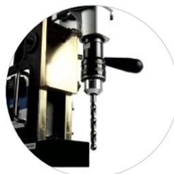
Foratura completa fino a 13 mm, con punte elicoidali
