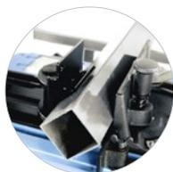
**DISPOSITIVO DI SERRAGGIO „K“ PER TUBI** Quadrati Per un processo di taglio sicuro e stabile (compreso nella fornitura)
