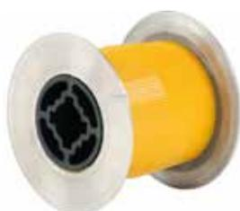
Rullo motore per l'utilizzo di nastri abrasivi fino a 30 mm di larghezza su POLY-PTX® e altre rettificatrici longitudinali con albero per chiavetta da 19 mm. Ideale per la lavorazione di tubi tondi aperti e chiusi.
